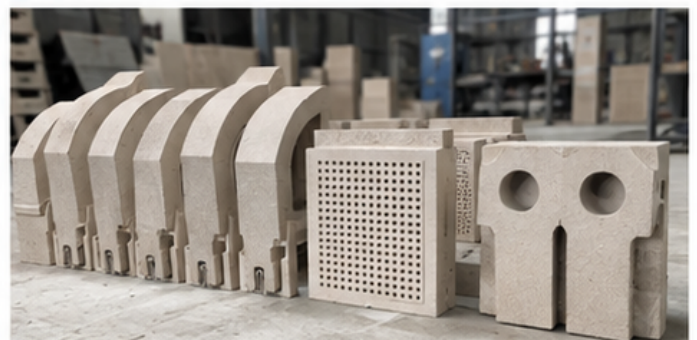
08 버너타일 및 인덕트 제작, 설치
